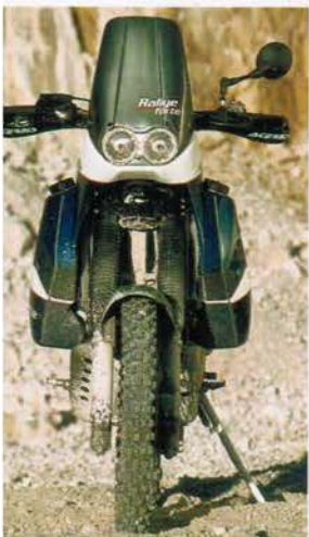
Sprittvorräte für große Reichweiten bunkert die Rallye Forte in je zwei Front- und Hecktanks.
