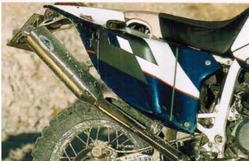
Sprittvorräte für große Reichweiten bunkert die Rallye Forte in je zwei Front- und Hecktanks.
