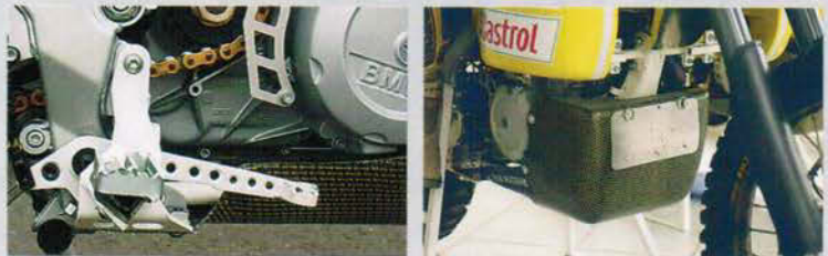
Perfekte Detaillösungen: speziell angepasste Fußrastenanlage und Motorschutz mit schwerpunktünstigem Staufach.
