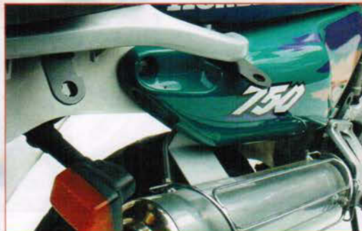
Dezent: Ohne Koffer verraten nur diese kleinen Halter das Klickfix-Gepäcksystem von SW Mo-Tech
