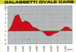
Prezzo al pubblico: 696.000 lire. Materiale: carbonio e acciaio inox. Peso: 2.454 grammi Potenza massima rilevata alla ruota: 38.40 CV a 6.750 giri/min. Coppia massima rilevata alla ruota: 4.93 kgm a 4.750 giri/min.
