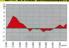
Prezzo al pubblico: 744.000 lire. Materiale: acciaio inox. Peso: 2.624 grammi Potenza massima rilevata alla ruota: 38.50 CV a 6.750 girl/mir Coppia massima rilevata alla ruota: 4.80 kgm a 5.000 giri/min.
