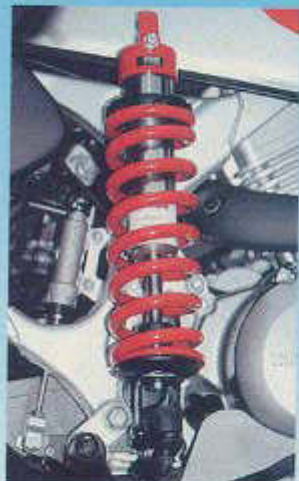
Am Bitubo-Dämpfer (799,- DM) von Alpha-Technik lässt sich die Zugstufe einstellen
